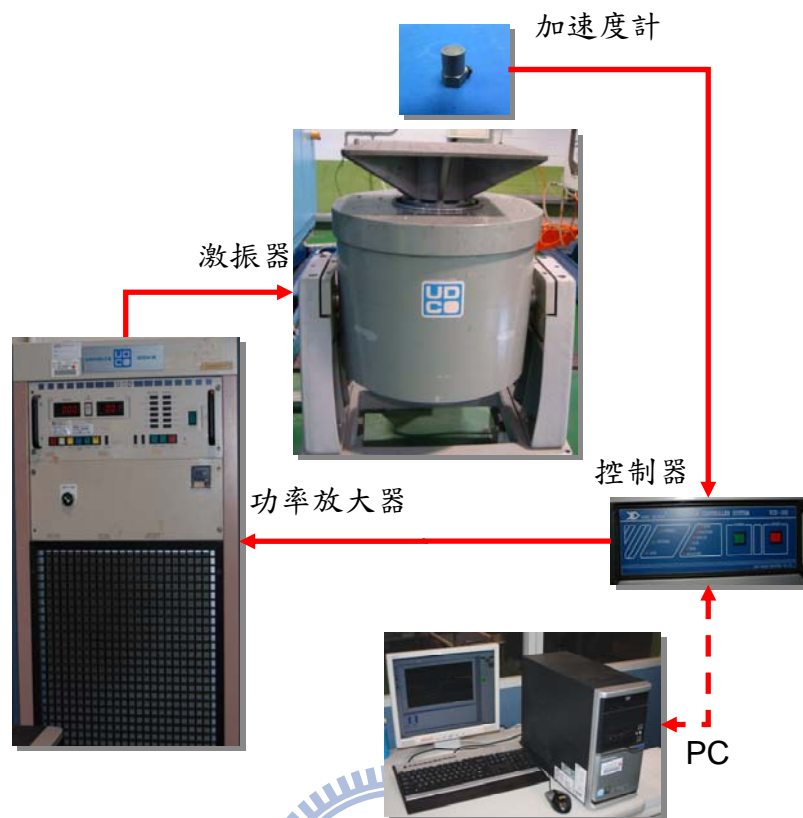
圖 12 強制激振（共振搜尋）實驗系統圖
