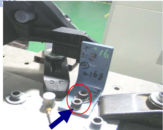
圖 19 支撐架與底板鎖附方式
