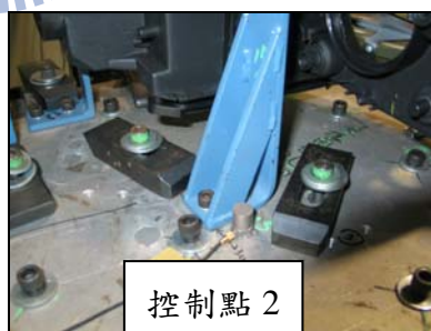
圖 28 車燈共振搜尋試驗量測加速度計安裝情形 (b)
