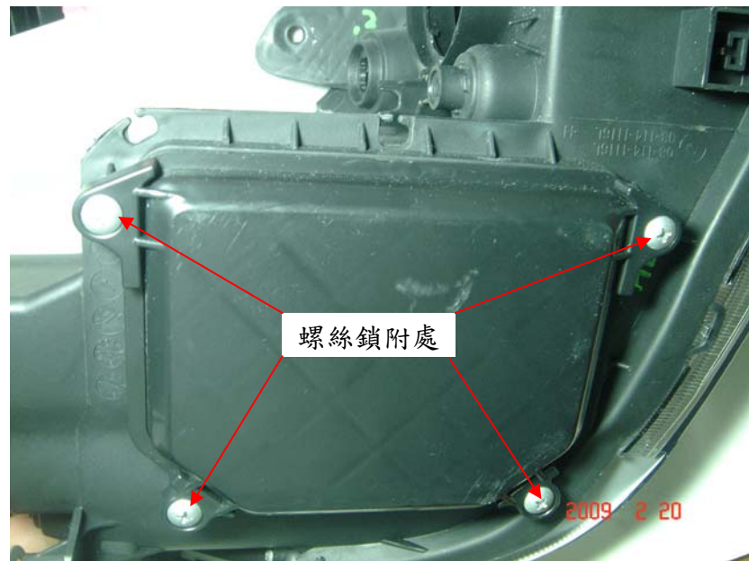
圖 60 後燈座與底蓋實物螺絲鎖附方式
