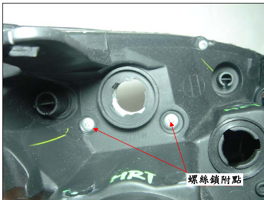
圖 62 方向燈反射鏡與後燈座螺絲鎖附方式
