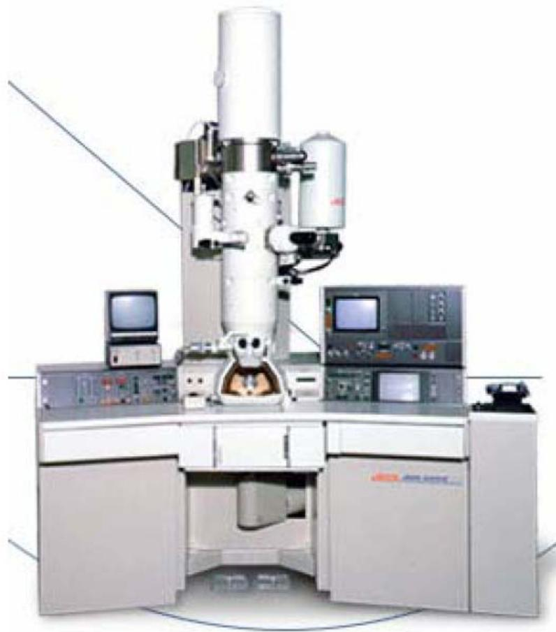
圖 3-5 穿透式電子顯微鏡
