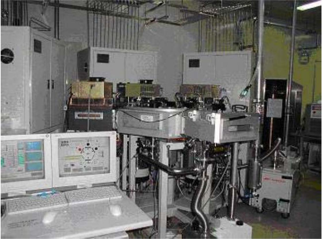
圖 3-1 高密度電漿化學氣相沉積系統
