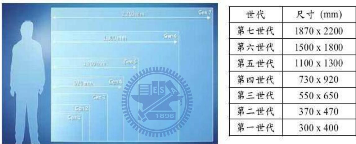
圖 4-1 LCD 玻璃基板尺寸
