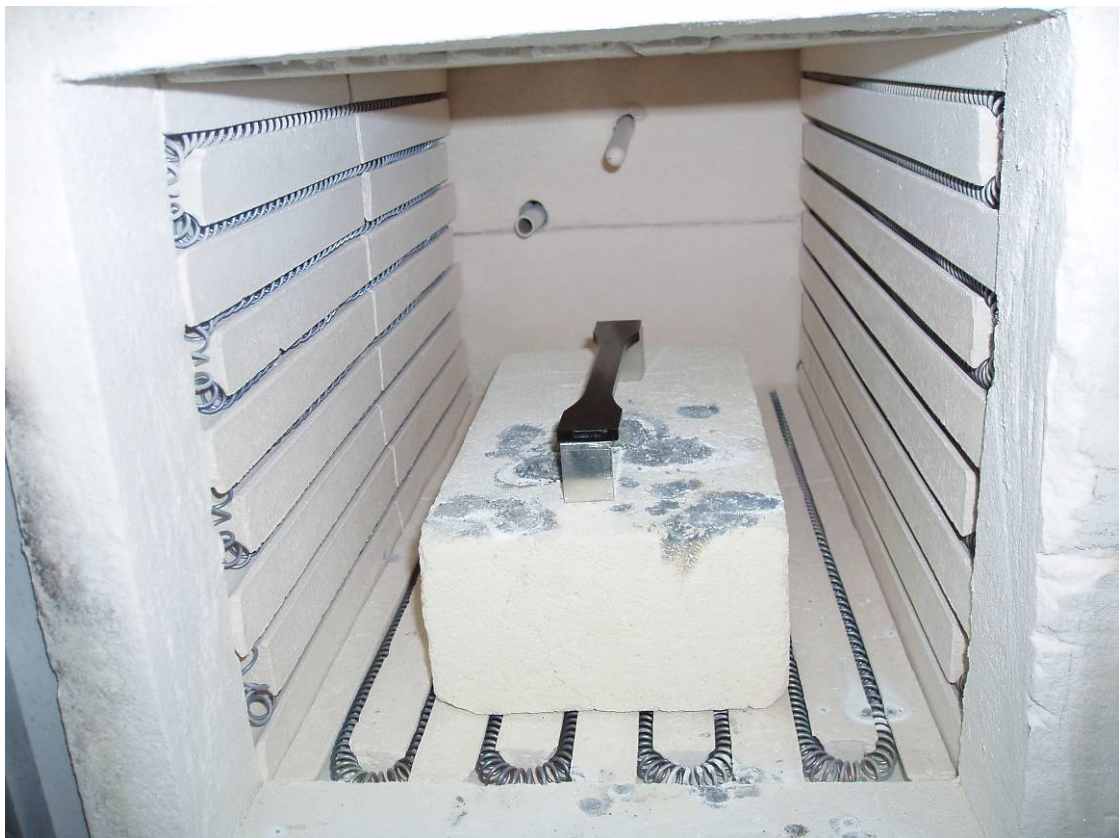
圖5-3 試片退火處理固定方式
