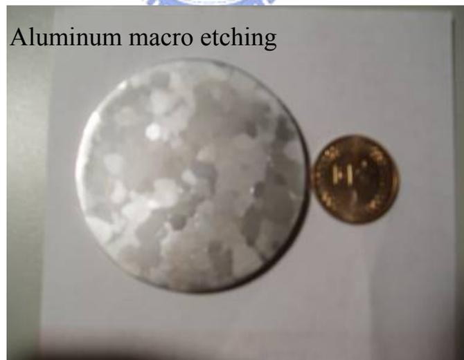
圖 4-10 99.7%A1 之晶粒大小，經過顯微鏡觀察；Macro etching 觀察鋁晶界
