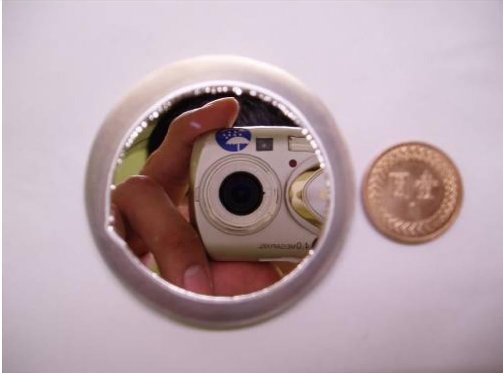
圖 4-11 電解拋光後呈鏡面之鋁基材；若電解拋光所需鋁基材越純(>99.999%Al)，其所拋光後之物件反射率會趨近於 100%，Al 基材表面越為平整
