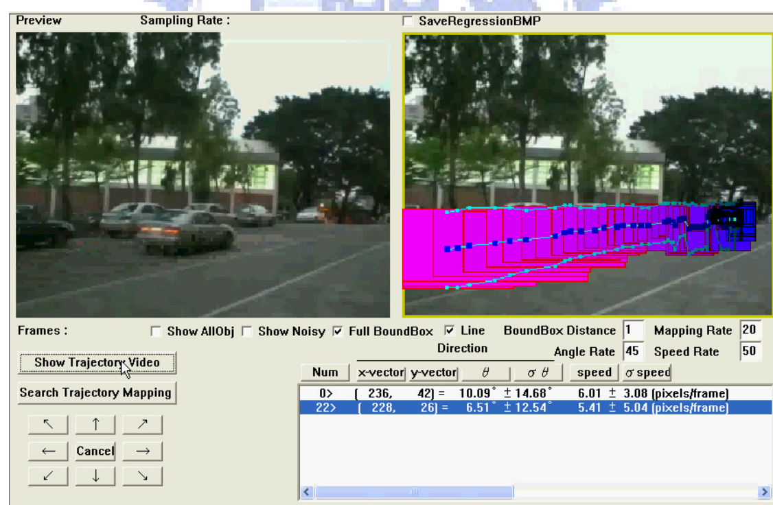
圖 3-19：圖形化使用者搜尋介面。右下方表格是代表一段影片內所包含物體的移動軌跡，而右上方視窗是顯示出目前所選擇到的物體其移動軌跡，其移動方向顏色是由淺至深表示。當想瀏覽該物體移動的視訊片段內容，點選“Show Trajectory Video”按鍵就會顯示在左上方視窗提供給使用者觀看。
