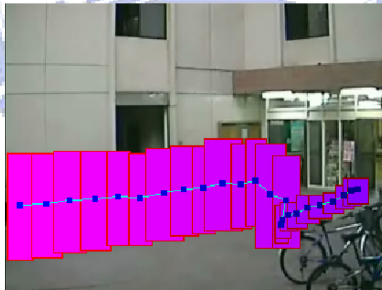
圖 3-9：使用區塊重疊方法追蹤圖 3-8 結果，人與狗的移動軌跡會混在一起。
