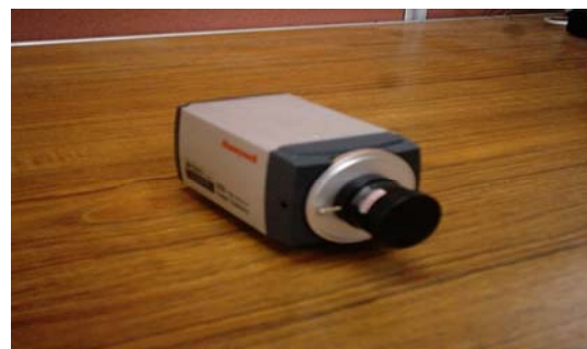
(b) CCTV Camera (具電子快門可拍快速移動物體)
