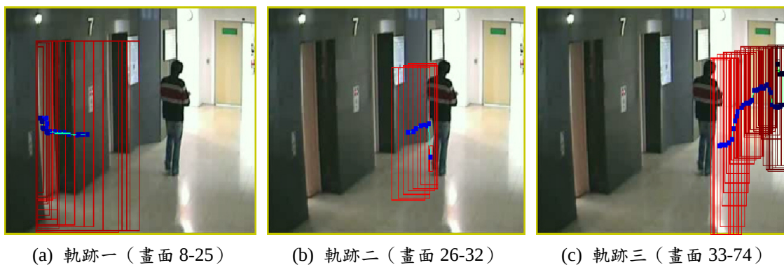
圖 4-20：追蹤失誤結果：單一物體移動卻有三個移動軌跡。
