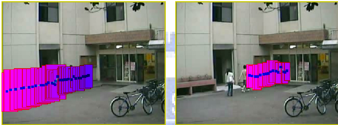
(a) 女生的移動軌跡：移動方向 11.03^\circ ， 移動速度 3.43 pixel/frame
