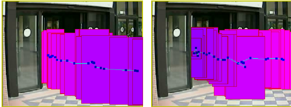
(a) 由左往右移動的行人 A 之移動軌跡：移動方向 305.17^\circ ，移動速度 12.10 pixel/frame (b) 由右往左移動的行人 B 之移動軌跡：移動方向 175.75^\circ ，移動速度 12.54 pixel/frame
