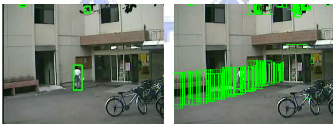
(a) 偵測到的前景物體用綠色的外接矩形框住 (b) 每一時間得到的外接矩形依時間順序全部顯示
