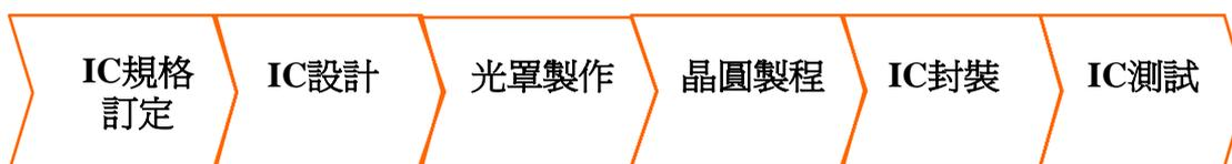
圖 3-7 IC 零件的製造過程
