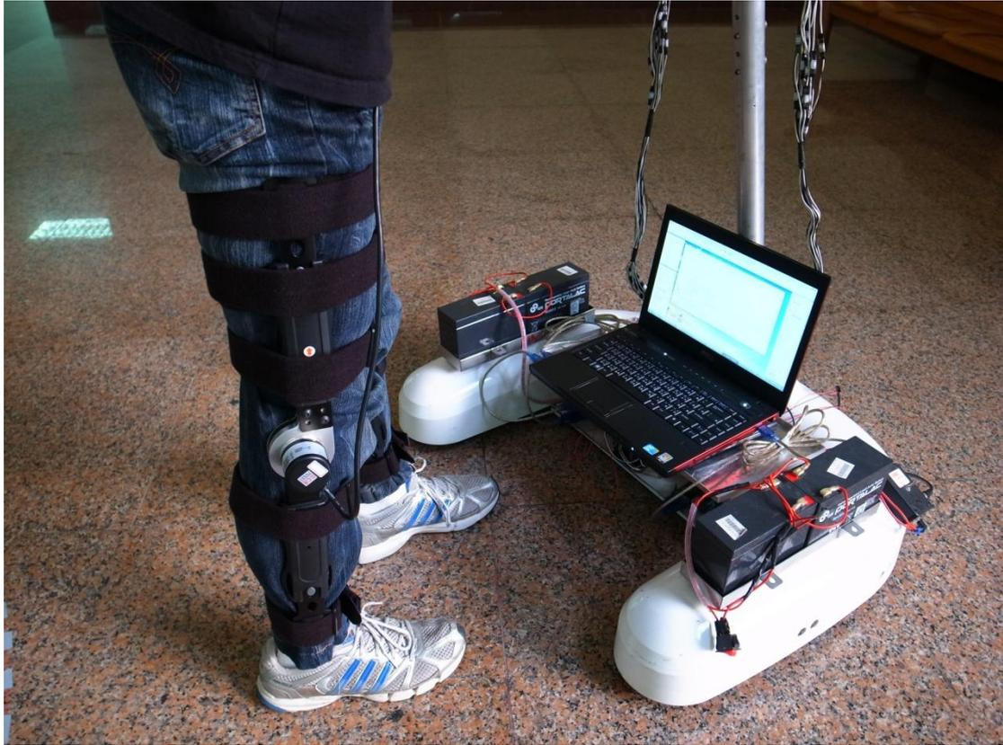
圖 4.1 模擬長者移動之膝關節角度限制支架
