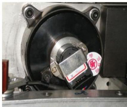
(b) 軸編碼器加裝於伺服煞車器
