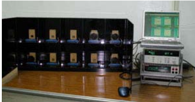
圖 63 自行組裝偵測光學穿透度變化的鈣測試儀器照片
