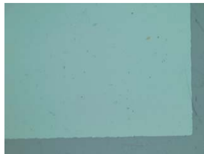
圖 36 (a) 光阻劑殘留 (b) 手套的粉末殘留 (c) 部份清洗的基板 (d) 基板清洗完成
