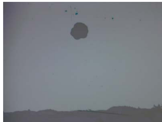
圖 31 光阻膜塗佈不均勻 (a)塗完光阻劑後 (b)蝕刻完成後
