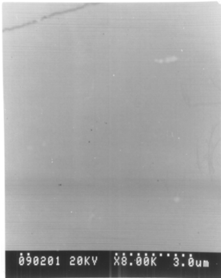
圖 30 (a)未蝕刻之 PET 塑膠基板 (b)蝕刻後之 PET 塑膠基板
