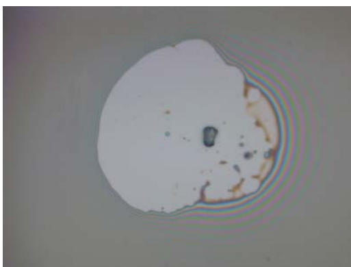
圖 31 光阻膜塗佈不均勻 (a)塗完光阻劑後 (b)蝕刻完成後
