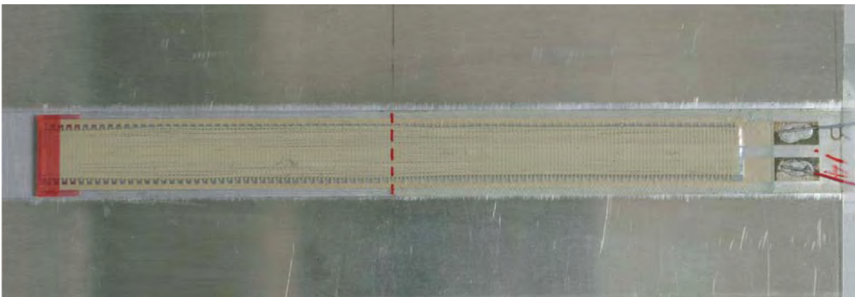
圖 3-25 Type-I PFC 黏貼在鋁板上並在纖維方向具有 65mm 的邊緣脫層
