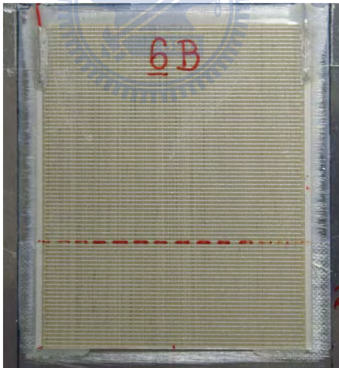
圖 3-40 Type-III PFC 黏貼在鋁板上並在纖維方向具有 20mm 的邊緣脫層
