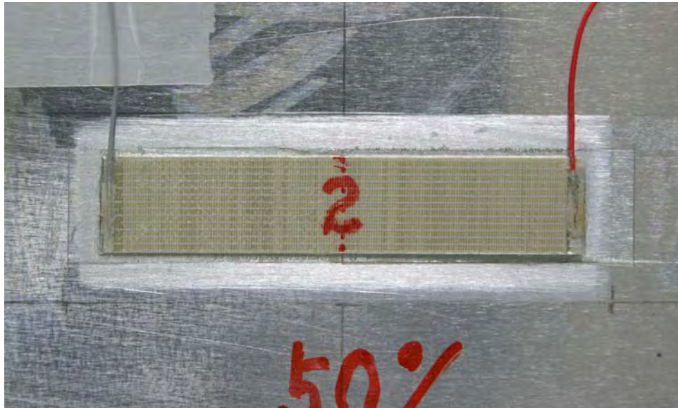
圖 3-55 Type-II PFC 黏貼在鋁板上並具有 25mm 脫層前緣與纖維方向平行的邊緣脫層
