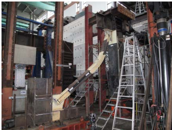
圖 5.9 試體 TGP2 之斜撐構材試驗行為與分析結果比較 (續)
