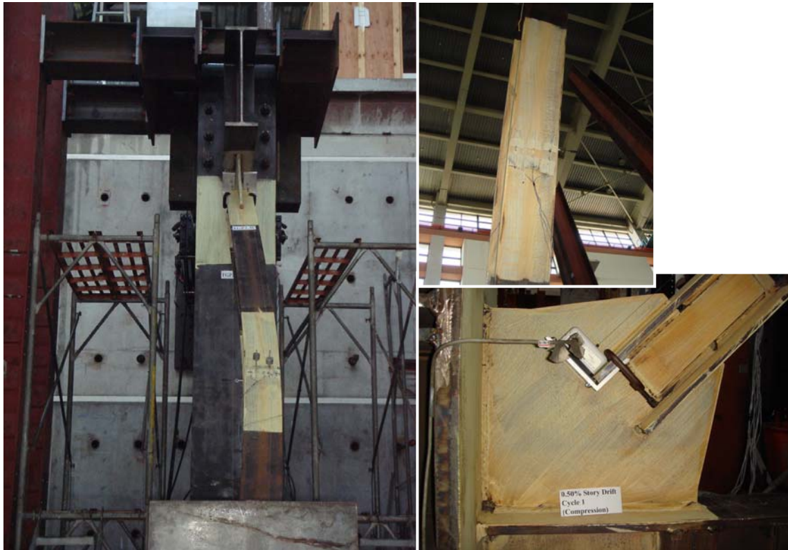
圖 4.46 斜撐整體挫屈與接合板受凹折石膏剝落情形 (0.5% 弧度 IDA)
