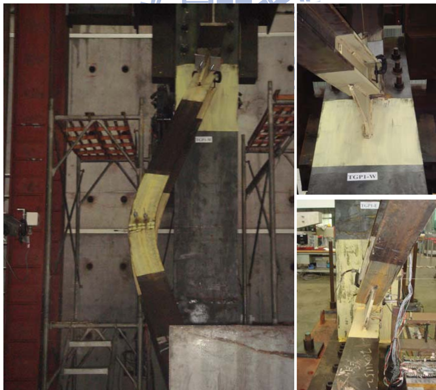
圖 4.42 斜撐與上下接合板受壓之變形情況 (3% 弧度 IDA)
