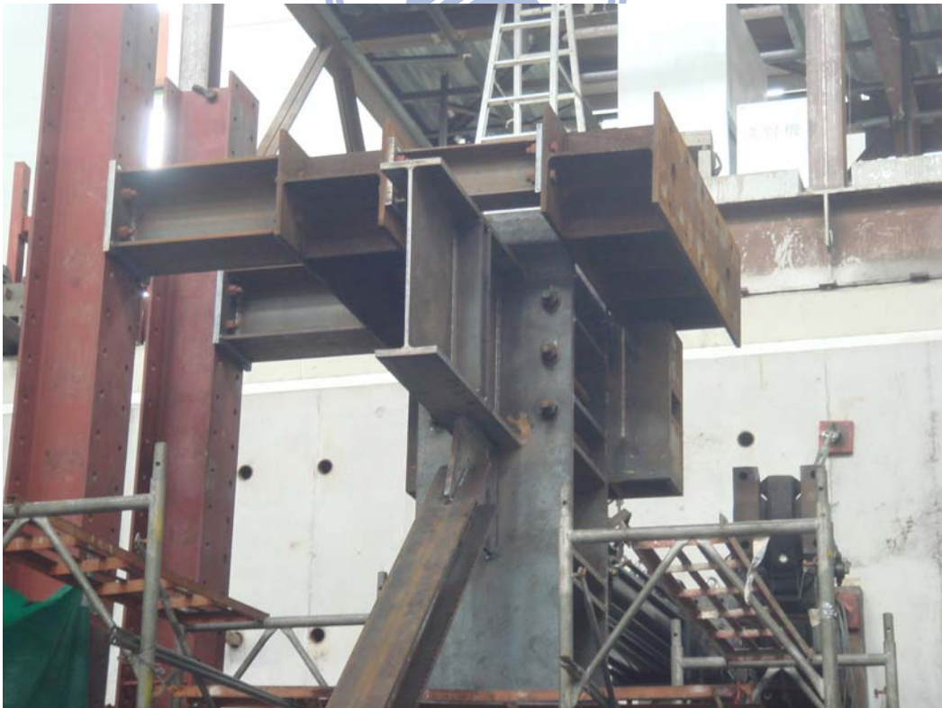
圖 4.31 柱端之側向支撐系統
