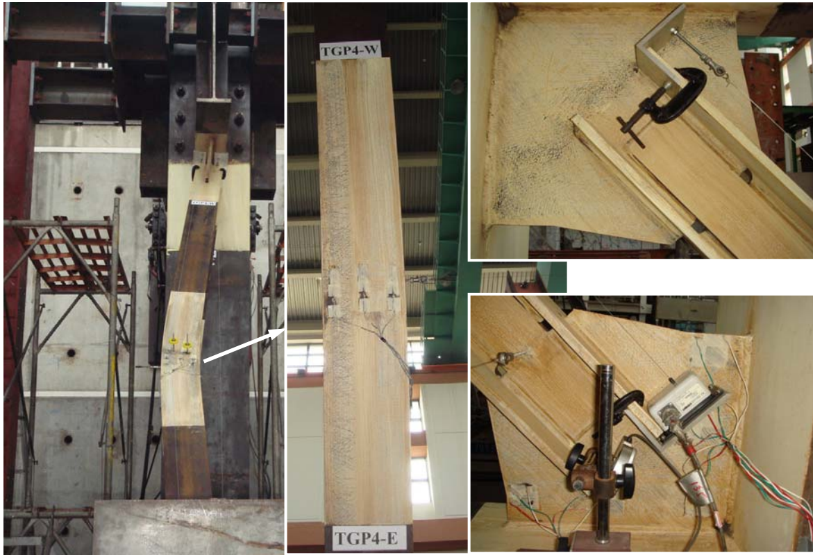
圖 4.51 試體 TGP4 產生初始挫屈之各部位變形情況 (0.5% 弧度 IDA)
