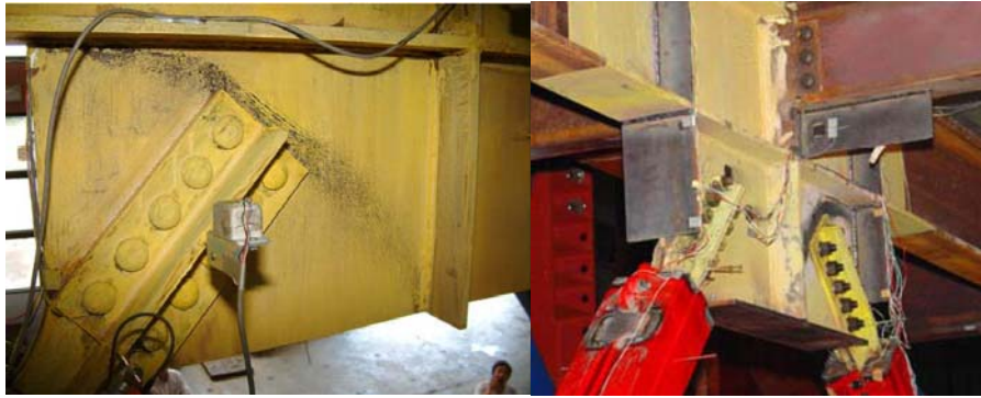
圖 2.10 挫屈束制斜撐之接合板產生挫屈之情況
