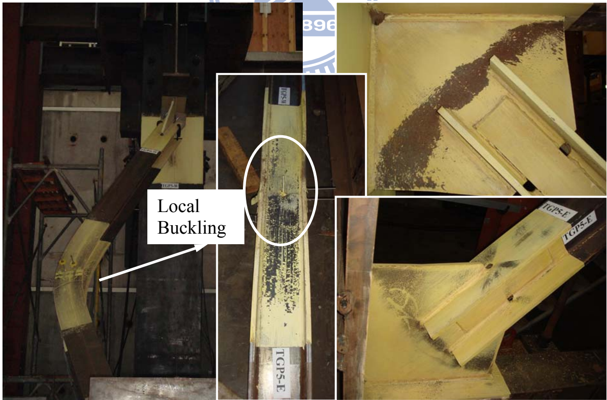
圖 4.57 試體 TGP5 最終破壞行為 (6% 弧度 IDA)
