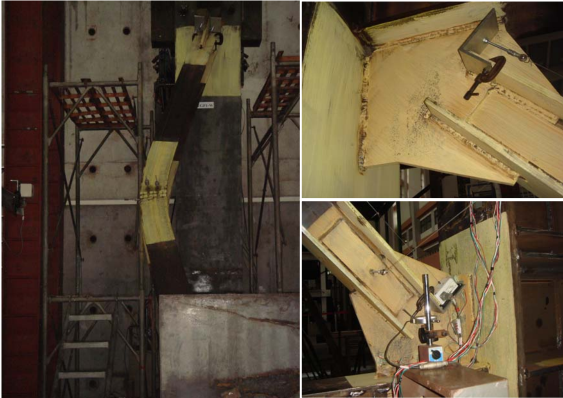
圖 4.41 斜撐中央處與上下接合板偏移區域變形情況 (2% 弧度 IDA)
