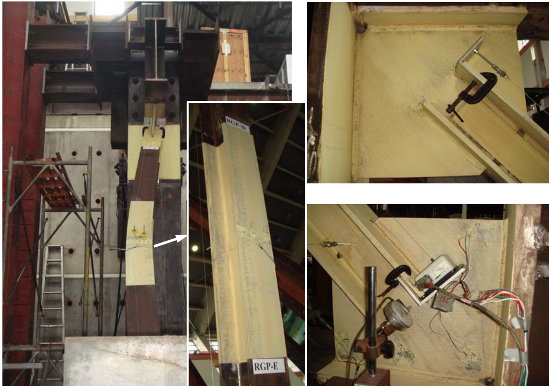
圖 4.58 試體 RGP 產生初始挫屈之各部位變形情況 (0.5% 弧度 IDA)
