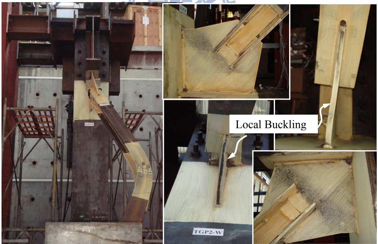
圖 4.47 試體 TGP2 最終破壞行為 (5% 弧度 IDA)
