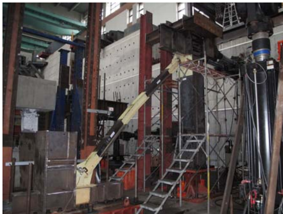
圖 5.7 試體 TGP1 之斜撐構材試驗行為與分析結果比較
