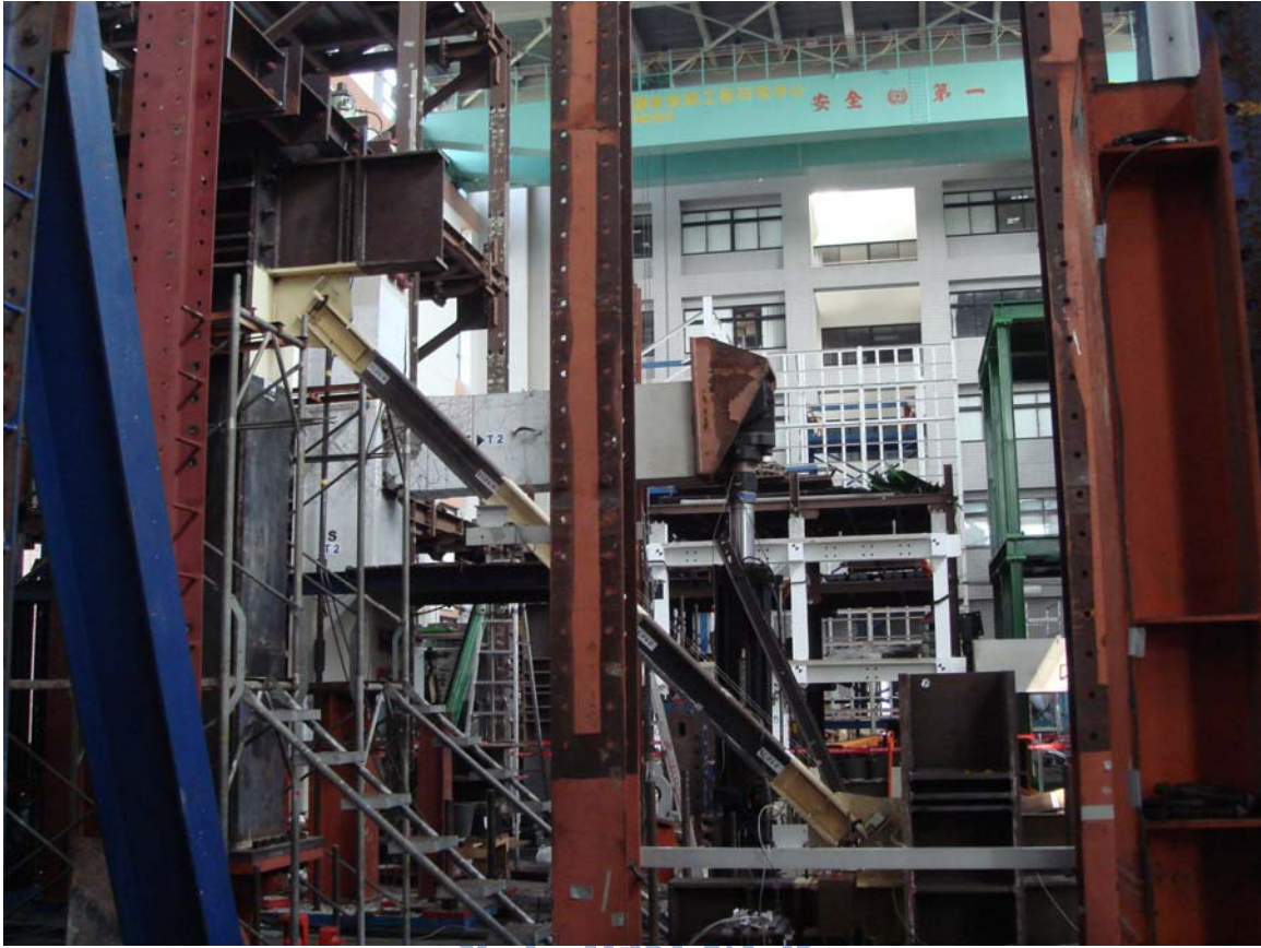
圖 4.30 載重試驗構架設置圖
