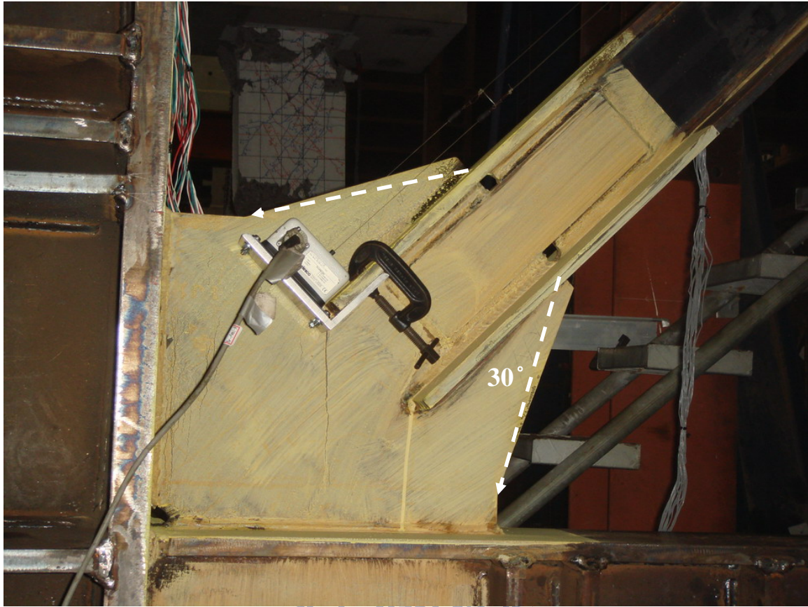
圖 4.39 下接合板於 30^\circ 擴散角區域石膏 45^\circ 剝落情形 (0.25% 弧度 IDA)
