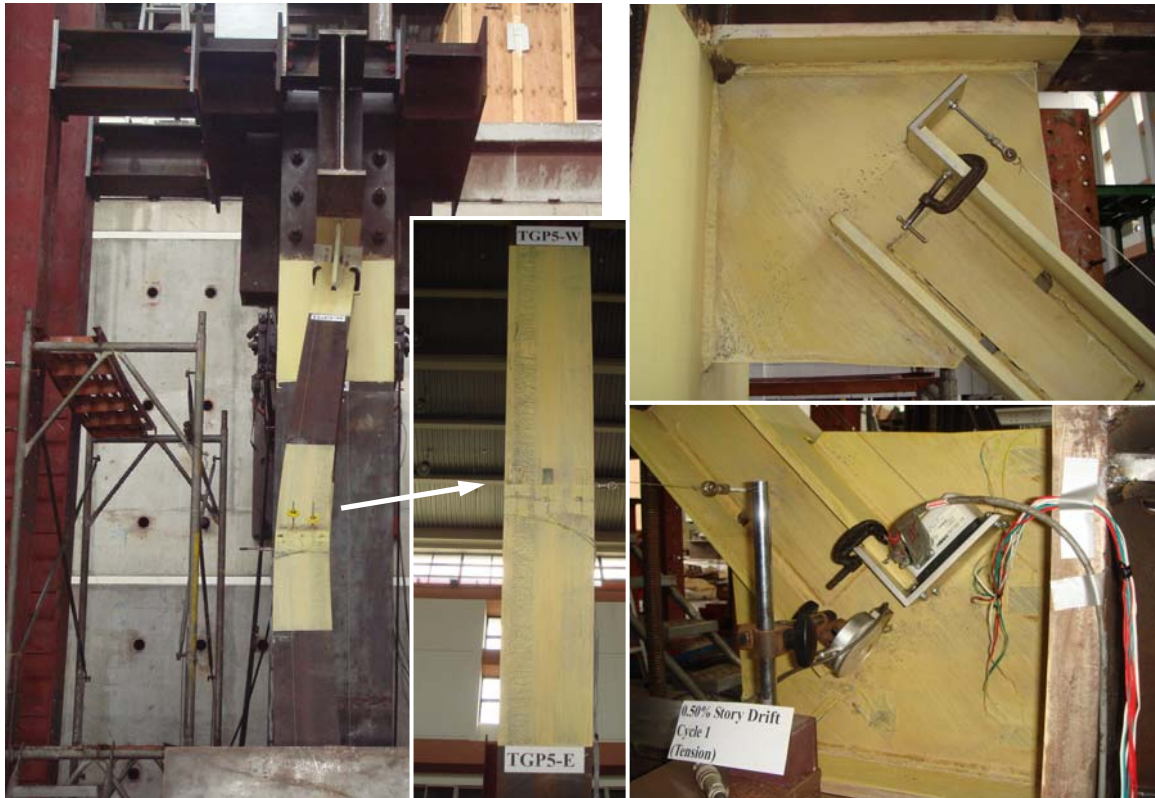
圖 4.54 斜撐初始挫屈與接合板受力行為 (0.5% 弧度 IDA)
