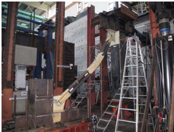
圖 5.9 試體 TGP2 之斜撐構材試驗行為與分析結果比較
