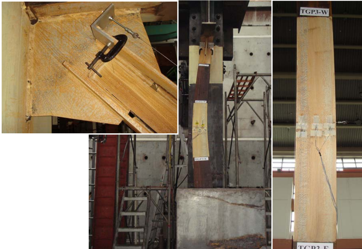
圖 4.48 試體 TGP3 初始挫屈與接合板凹折紋路情形 (0.5% 弧度 IDA)
