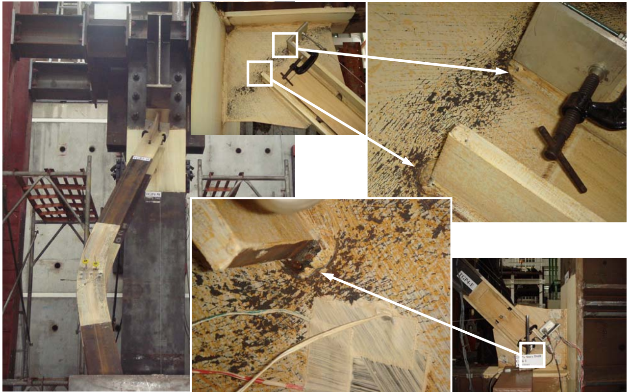
圖 4.52 接合板與斜撐接合填角銲道端部鋼材撕裂情形 (2% 弧度 IDA)
