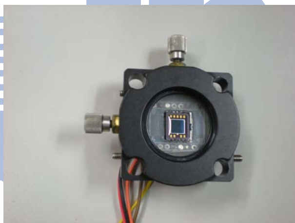
圖 3-3 四象限光偵測器裝置圖
