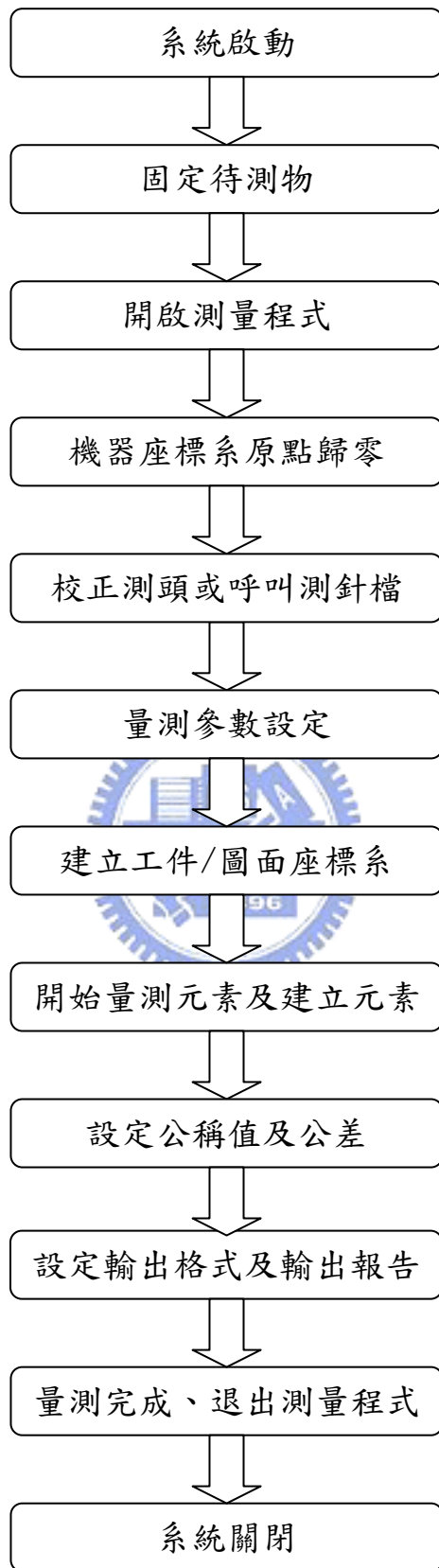
圖 2.7 三次元測量機之操作程序
