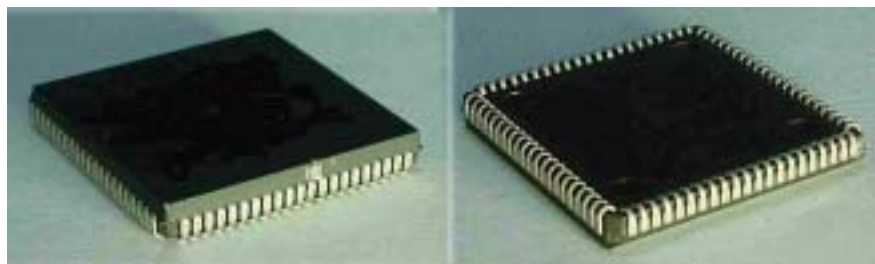
圖 2-10 LCC 之 J 型腳構裝型式
