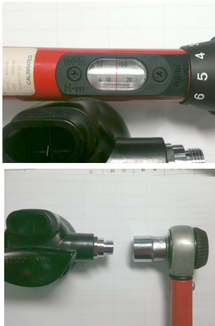
圖 5.33 以扭力板手對調節器的螺拴施力
