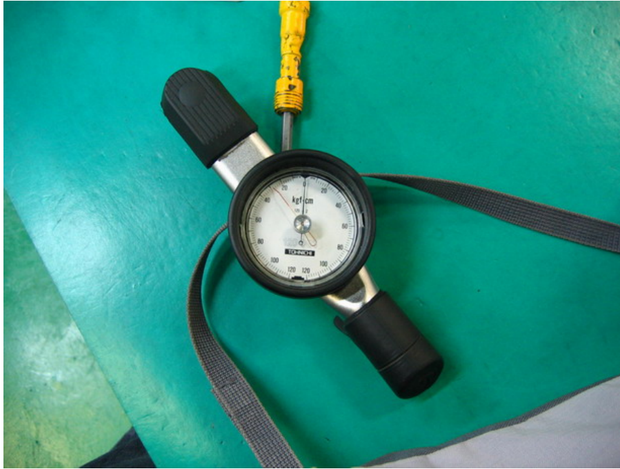
圖 5.54 扭矩實驗使用之扭力扳手
