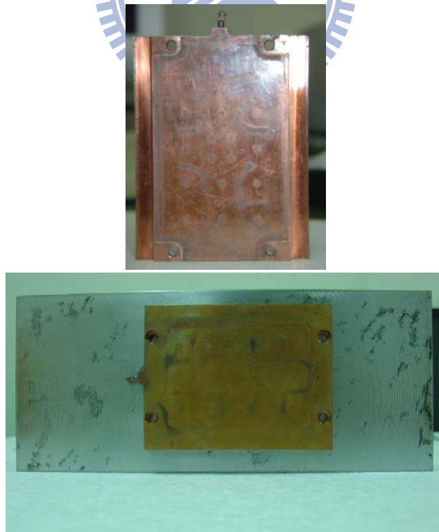
圖 5.2 均溫板外觀以及安裝於模仁上的狀況
