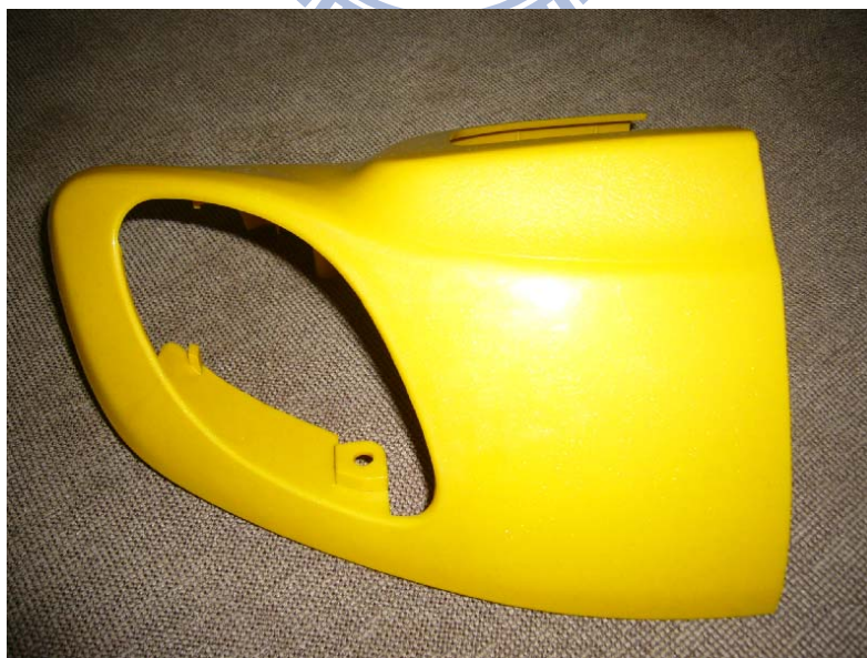
圖 3.6 採用添加金屬粉末塑料成形的機車頭燈外殼件
