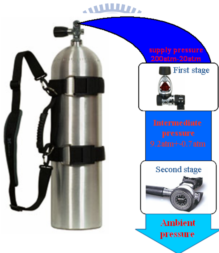
圖 5.31 開放式呼吸調節器元件示意圖
