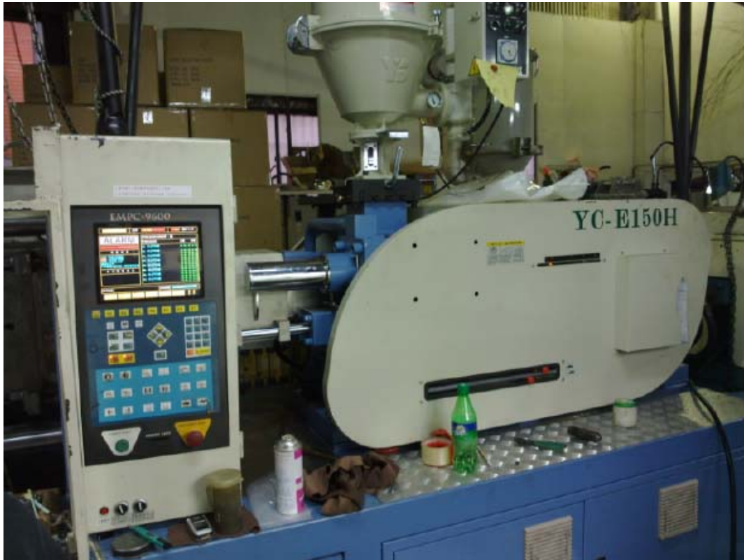
圖 5.37 呼吸調節器之成形機台
