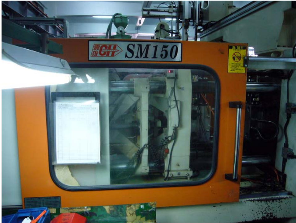
圖 5.18 安裝於射出成形機上之模內旋轉模具
