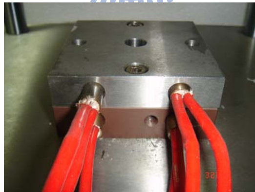
圖 5.25 沖模模具（已安裝加熱棒）
