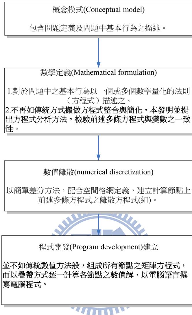
圖 2.2 可適性計算架構建模流程圖
