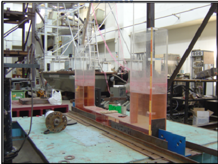
圖 2.26 TLCD 系統之水平向試驗組裝圖
