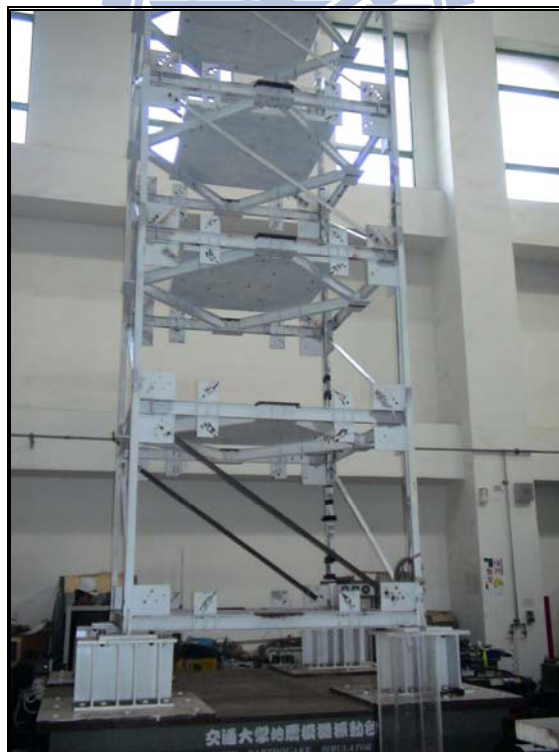
圖 4.28 五層樓鋼構(移除二樓雙邊斜撐)
