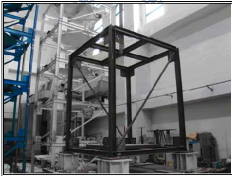
圖 3.33(b) 單層樓 FPS 結構試驗模型
