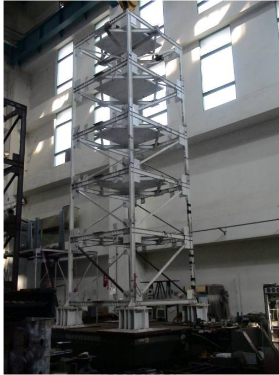
圖 4.27 五層樓鋼構(未受損結構)
