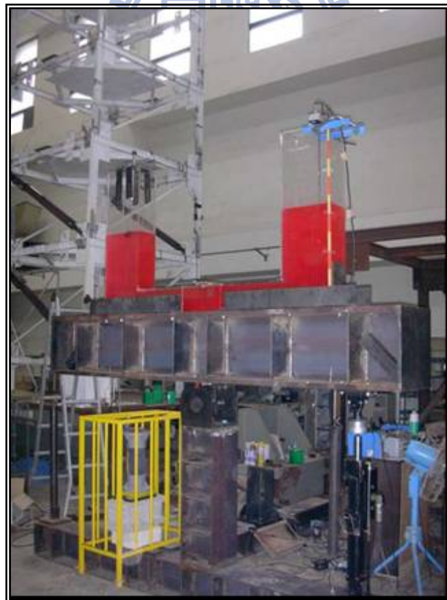
圖 2.39 TLCD 元件之旋轉運動試驗
