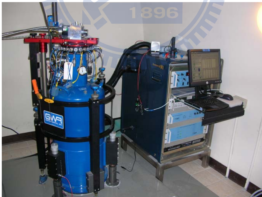
圖 5-4：新竹超導重力站 HS 之重力觀測情形 (取自內政部國家重力基準站)
