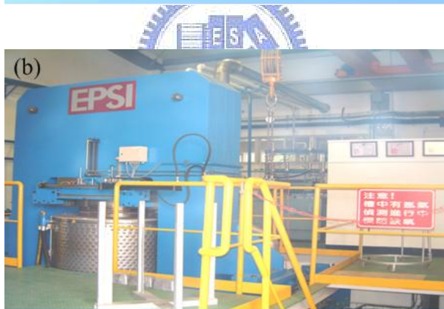
圖 2-8 (a)熱均壓設備示意圖(b)EPSI 商用熱均壓設備照片
