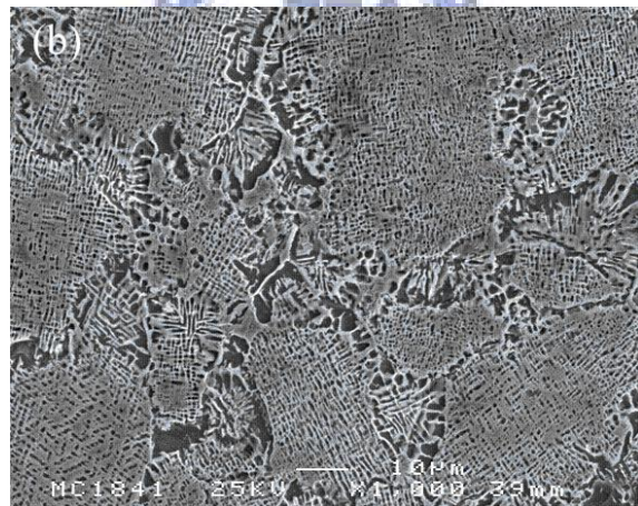
圖 4-27 11C 於 982°C/200MPa 潛變測試後顯微組織(a)橫截面、(b)縱切面
