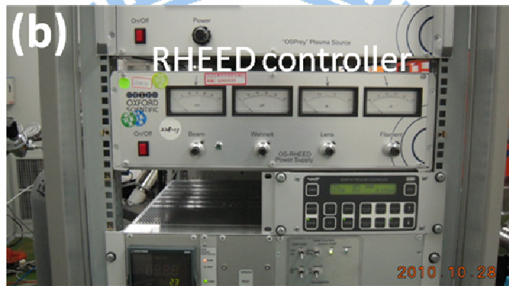
圖 3-17.(a)本研究所使用之 DCA PLD-500 系統所配的 RHEED gun(RHD-30) (b)配合 RHD-30 之電子束控制裝置
