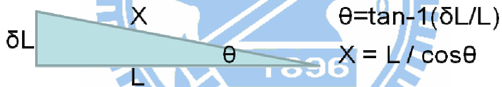
圖 5-3. (a)以鋁酸釧單晶斜切角 \theta 為例其切面示意圖。(b)當斜切角 \theta 之斜面其長度隨 \theta 變化之關係。
