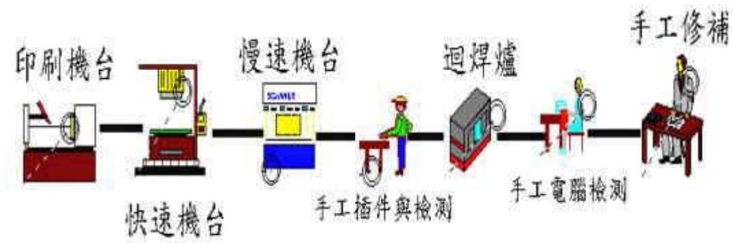
圖 2-12 其他電子零組件 SMT 製程流程
