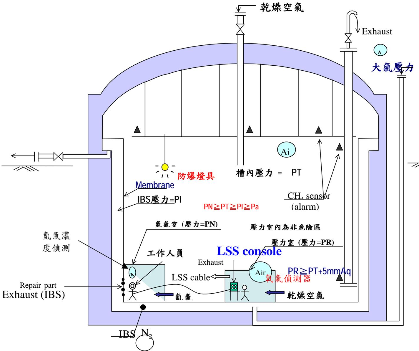
註：圖中大氣壓力(PA)：0 mmAq、IBS 壓力(PI)：0 ~ 5 mmAq、
