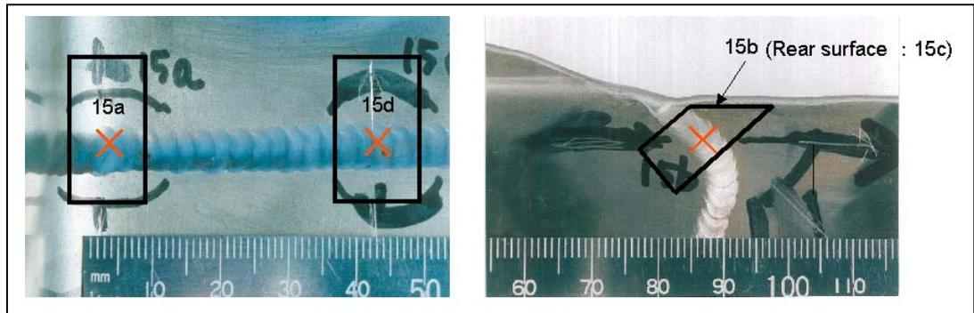
圖 23 SS304 不銹鋼銲道低溫韌性測試。
