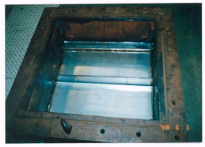
圖 27 邊緣銲道試片固定密封於壓力槽底部
