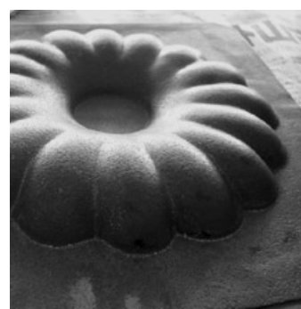
重複退火、沖壓步驟數回至所需立體深度
