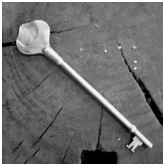
將各部件焊接，完成
