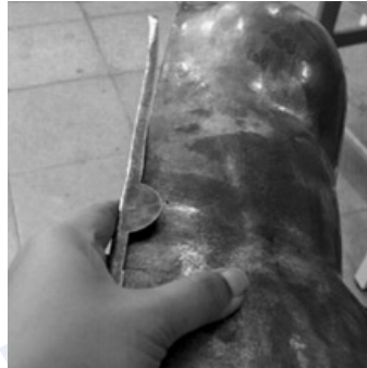
確認包邊於馬甲主體的位置，進行包邊曲度的敲整
