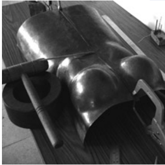
包邊嵌入主體內緣後細調至完全密合，從背面將包邊焊接
