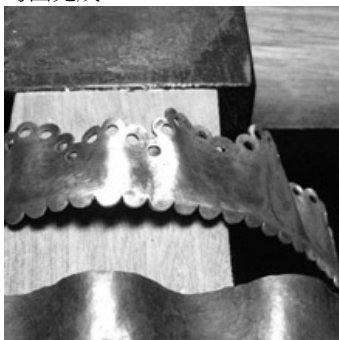
整平後，鋸形及鑽孔
