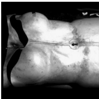
將左右兩半焊接起來，將主體形狀鋸出
