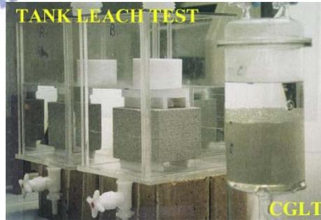
圖 2-10 Tank 浸出測試 NEN7345 標準；[27]
