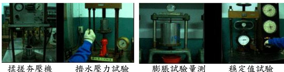
照片 4-4. 路基土壤阻力 R 值 (Resistance Value) 試驗
