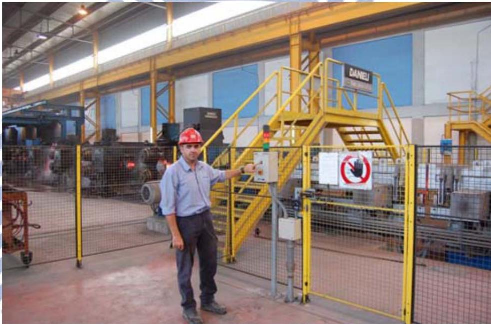
圖 12 部分生產線增設金屬防護網並設置連動警報裝置成果
