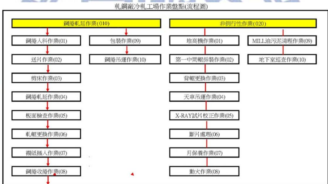
圖 28 A 鋼鐵廠辨識出所有的作業之作法
