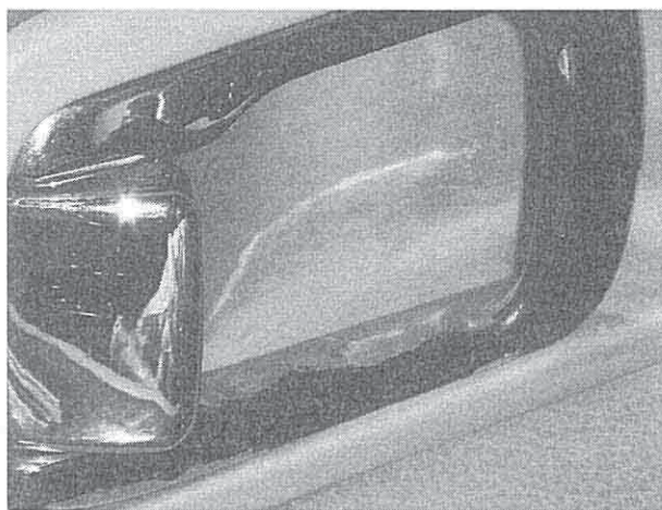
圖 1-14 傳統電鍍剝落現象及龜裂現象
