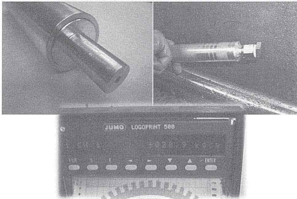
(c) 鐸接改善後 SGS 水壓測試
