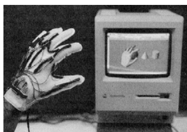
圖 2-13 手套控制介面 (Zimmermann et al., 1987)
