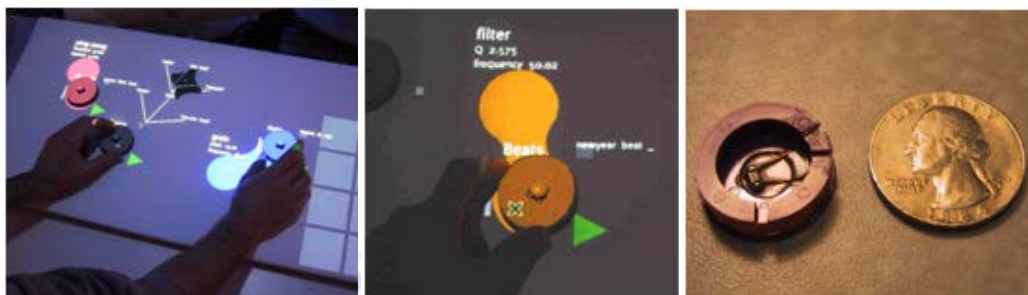
圖 2-36 (A)Audiopad 裝置 (B)旋轉移動實體控制圓盤 (C)RF 感應器
