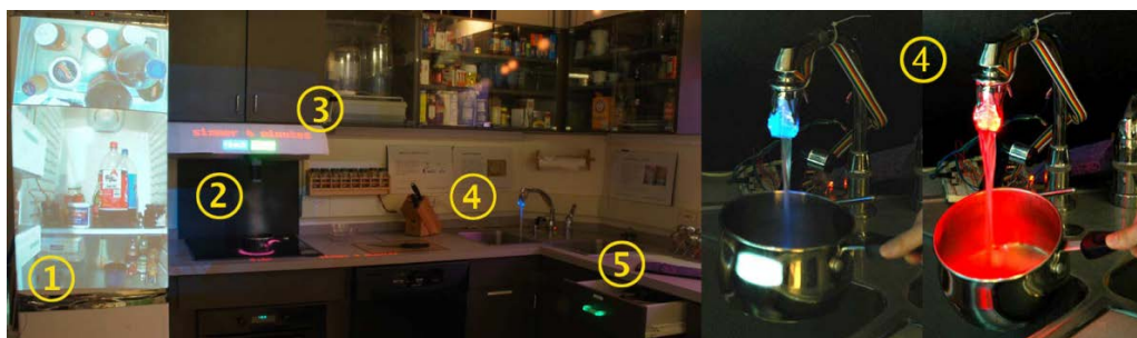
圖 2-26 擴增實境的智慧廚房：(1)冰箱內部儲存的投影；(2)正在烹煮食物的溫度、時間顯示；(3)儲存櫃內部的投影；(4)LED 色彩輔助冷熱水的顯示；(5)提示的 LED 顯示抽屜 (Bonanni et al., 2005)
