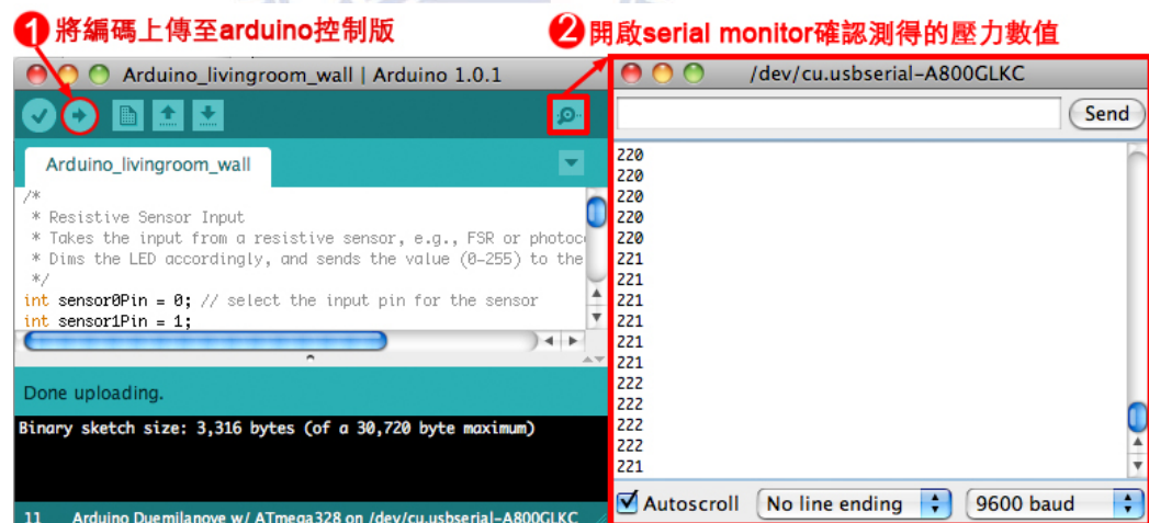
圖 6-10 Arduino 藉由 serial monitor 所測得的壓力數值 val (因本論文將所測得訊號值 0~1024 除以 4，因此單一 FSR 所測得壓力值為 0~255)
