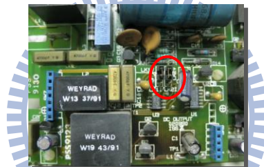
圖 C-20(c)實際接腳位置(紅色圈選處)，目前為電壓輸出
