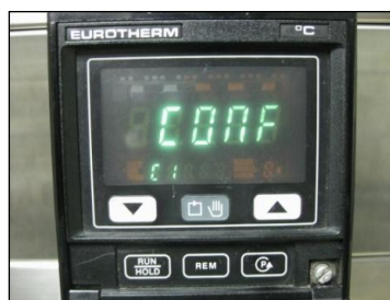
圖 C-18 Eurotherm 818P 進入組態變更視窗
