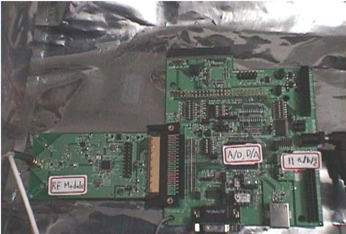
圖 5.1.8 RF Module and A/D、D/A Convertors
