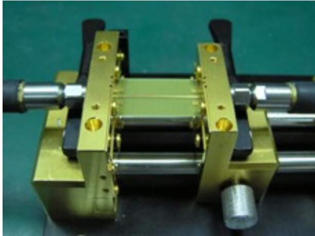
圖7. 測試夾具與 TRL Calibration Kit
