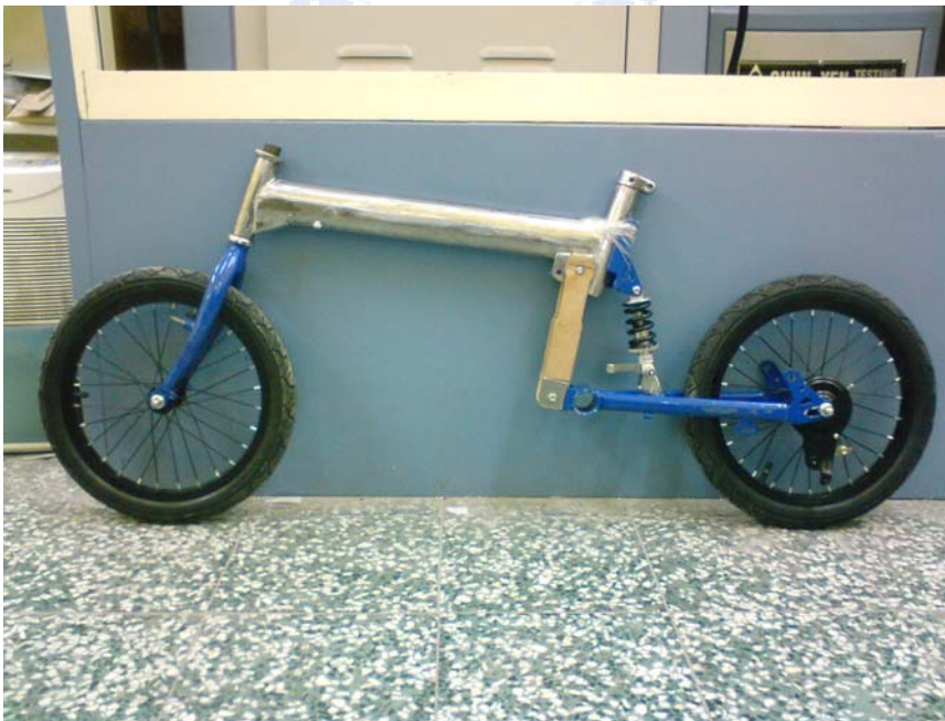
圖 78 套用 16 吋車胎與相關零件配置幾何比例及相對位置
