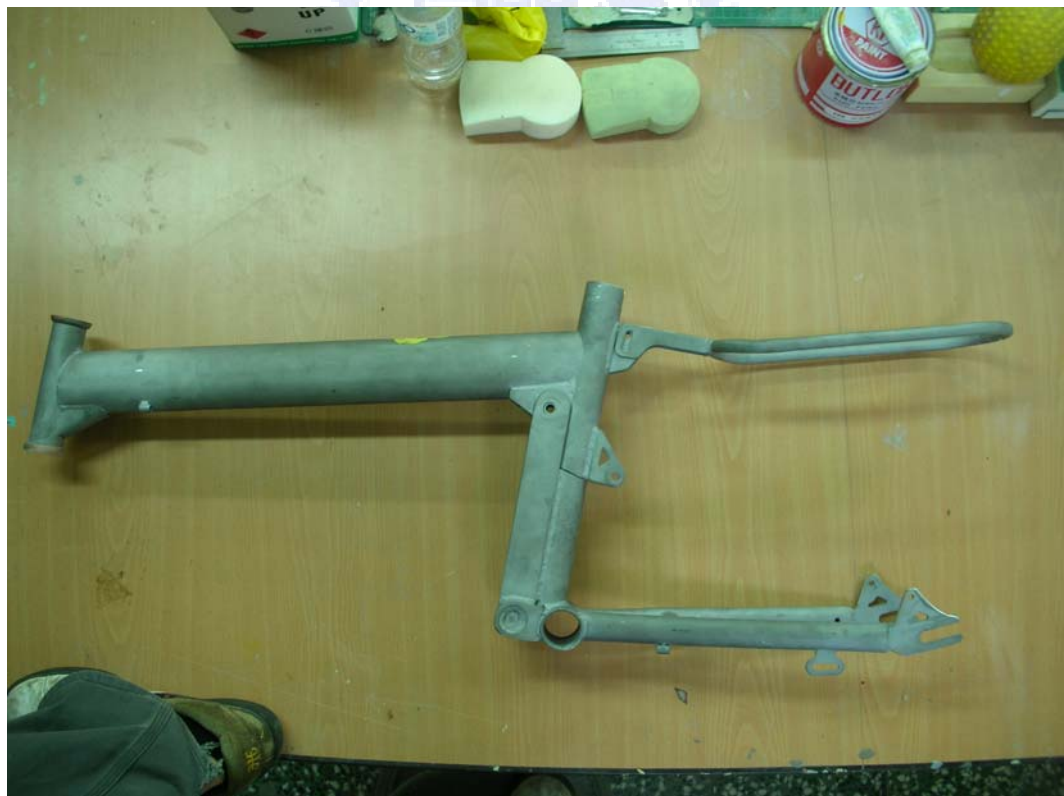
圖 82 焊接與噴砂完成之素車架
