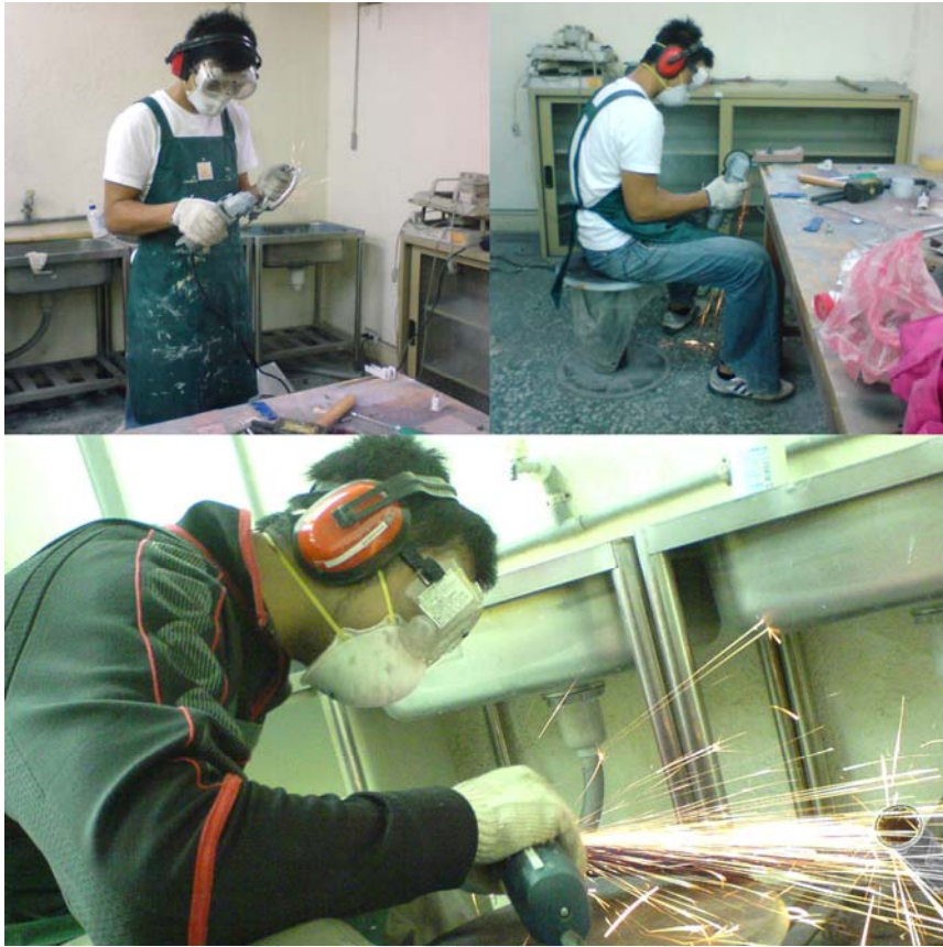
圖 77 以手動砂輪機進行金屬(鐵、鋁)接割與研磨加工
