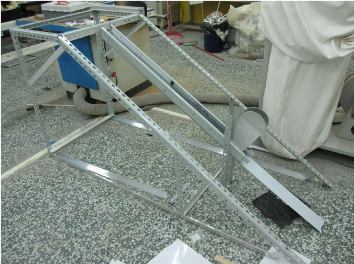
圖 85 以角鋼及鋁材進行停車架框架製作
