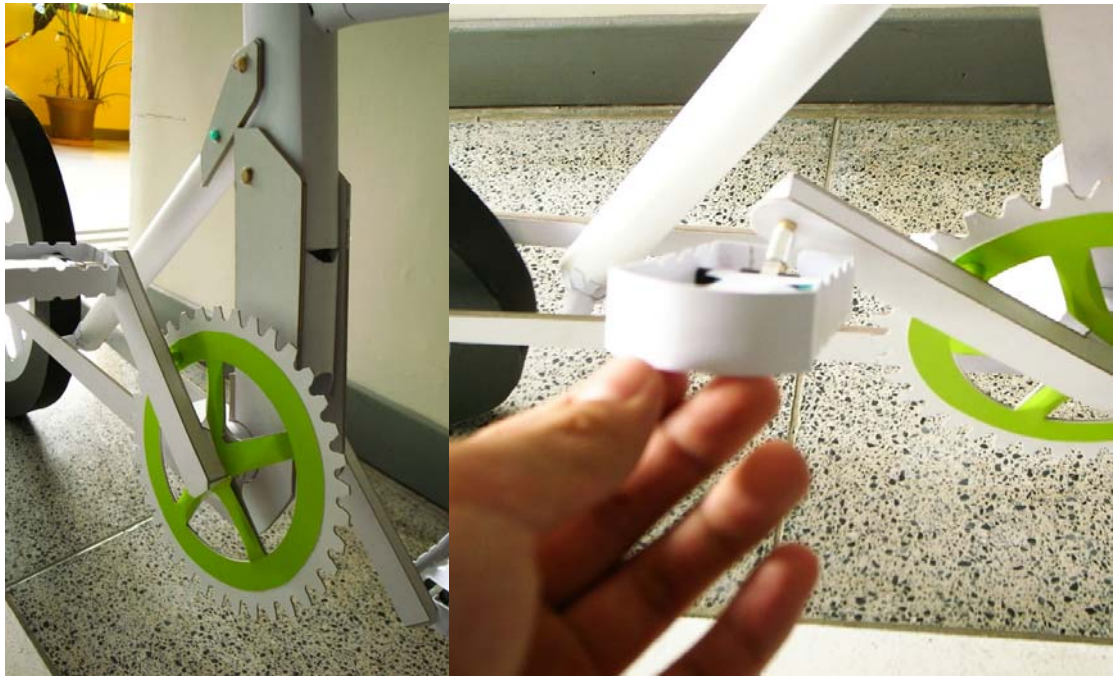
圖 75 縱向摺疊機構局部特寫與摺疊踏板示意
