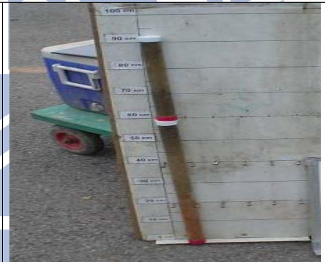
不擾動套管式採土器設備鑽探至預定深度，取出換成雙套管採樣管
