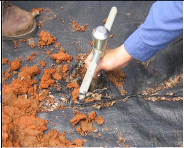
至預定採樣的位置，將螺旋採樣桿置入，取得表層土壤樣品
