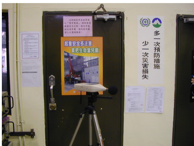
圖 4-10 控制室隔音鐵門外量測點
