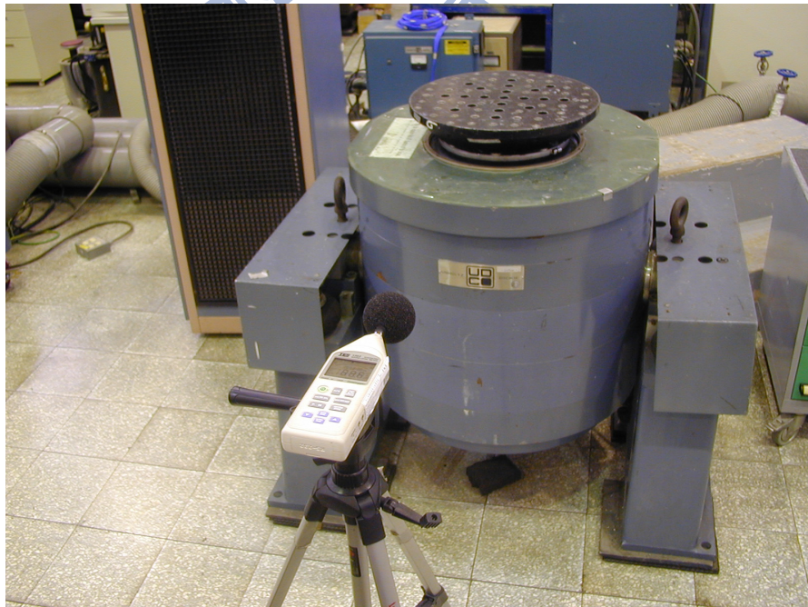
圖 3-28 垂直振動機 主要之噪音源定點量測
