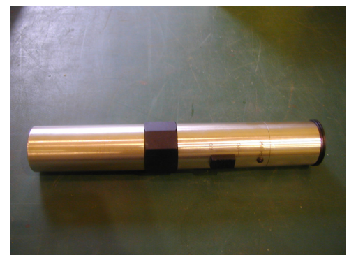
圖 3-12 B&K4220 活塞式校正器
