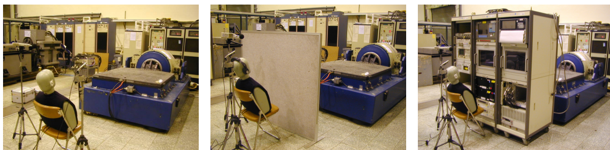
圖 4-1 直接音、隔音屏障的比較-現場量測佈置
