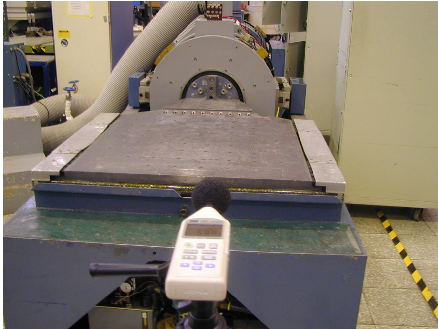
圖 3-27 水平振動機主要之噪音源定點量測
