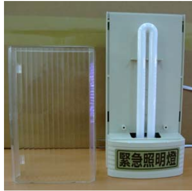
圖 83 照度分佈測試樣品 4 資料來源：本研究拍攝
