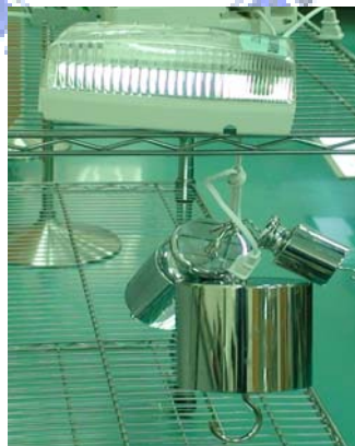
圖 44 電源線拉放試驗 資料來源：本研究拍攝
