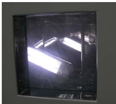
圖 55 環境 70°C 燈具效能試驗 資料來源：本研究拍攝
