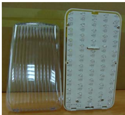
圖 92 照度分佈測試樣品 7
