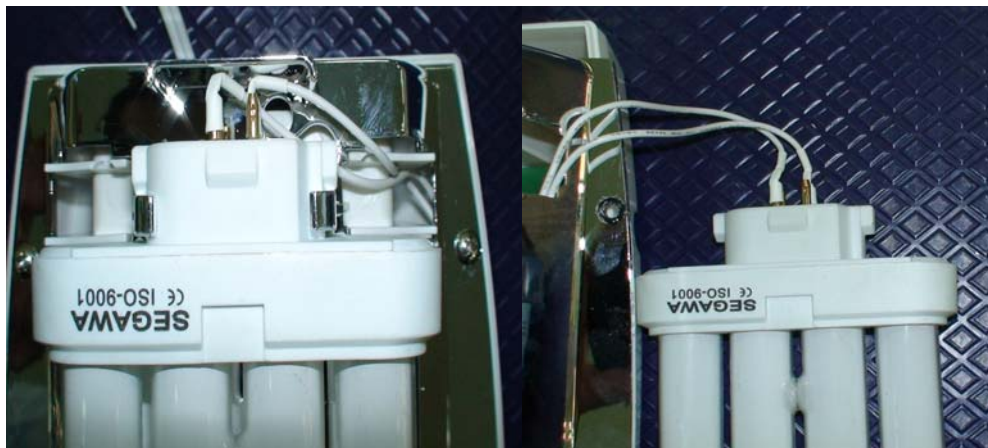
圖 57 國內緊急照明燈燈頭連接方式
