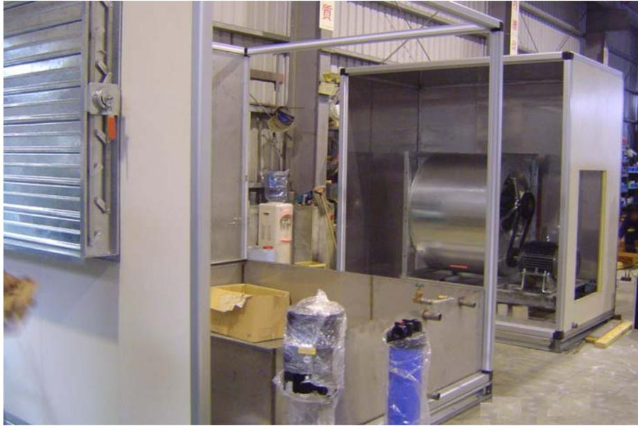
圖 3. 9 Air Washer 風車段內部圖
