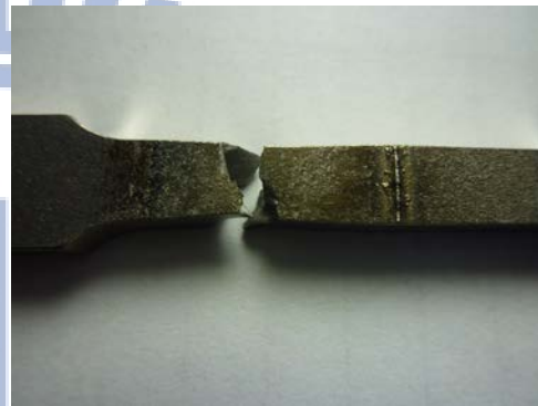
(d) R. M+AL+S. T. +A. A. +EBW+S. R. C. 試片
