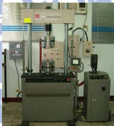
圖 13 MTS-810 萬能試驗機
