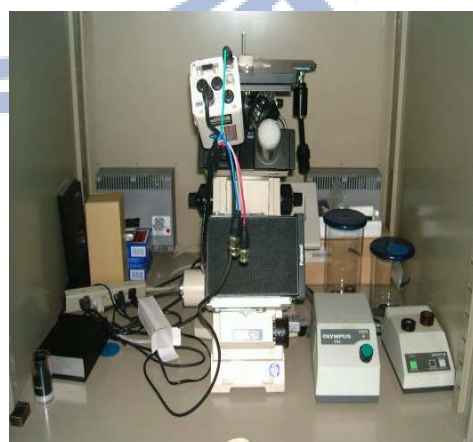
圖 15 OLYMPUS PME3 光學顯微鏡
