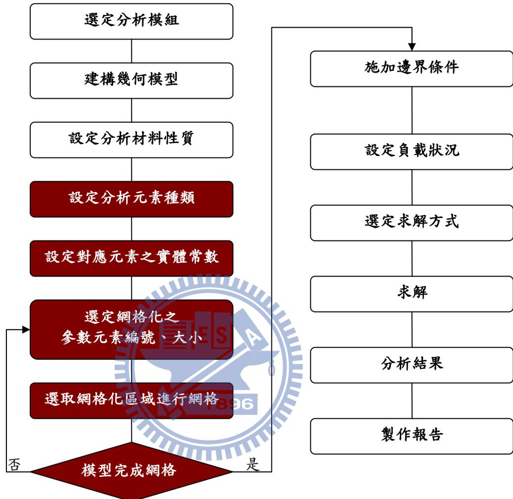
圖 3. 11 CAE 的使用流程（紅底部分為 COMOSWorks 自動設定）
