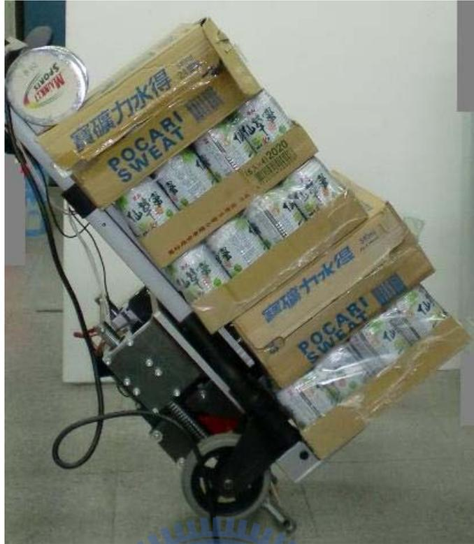
圖 6. 10 爬梯機荷重測試
