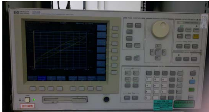
圖2-12 HP 4156 TFT元件分析量測機台
