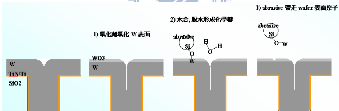
圖 2-11 Tungsten CMP 研磨機制
