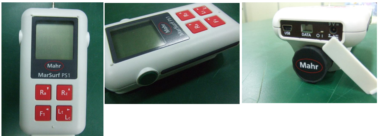
圖 3-11 Mahr - MarSurf PS1粗糙度量測機台外觀
