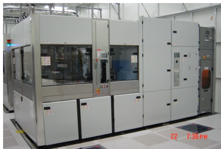
圖 3-9 美商應用材料AMAT 300mm Reflexion CMP機台外觀
