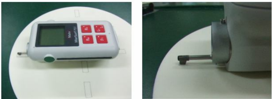
圖 3-14 Mahr - MarSurf PS1粗糙度量測過程
