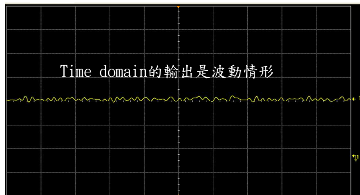
圖1-2 CW(continuous wave)輸出 用高解析度40GHz 示波器量測
