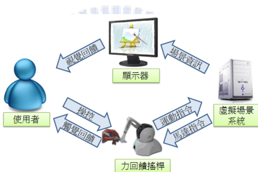
圖 1-1 虛擬毛筆系統架構圖
