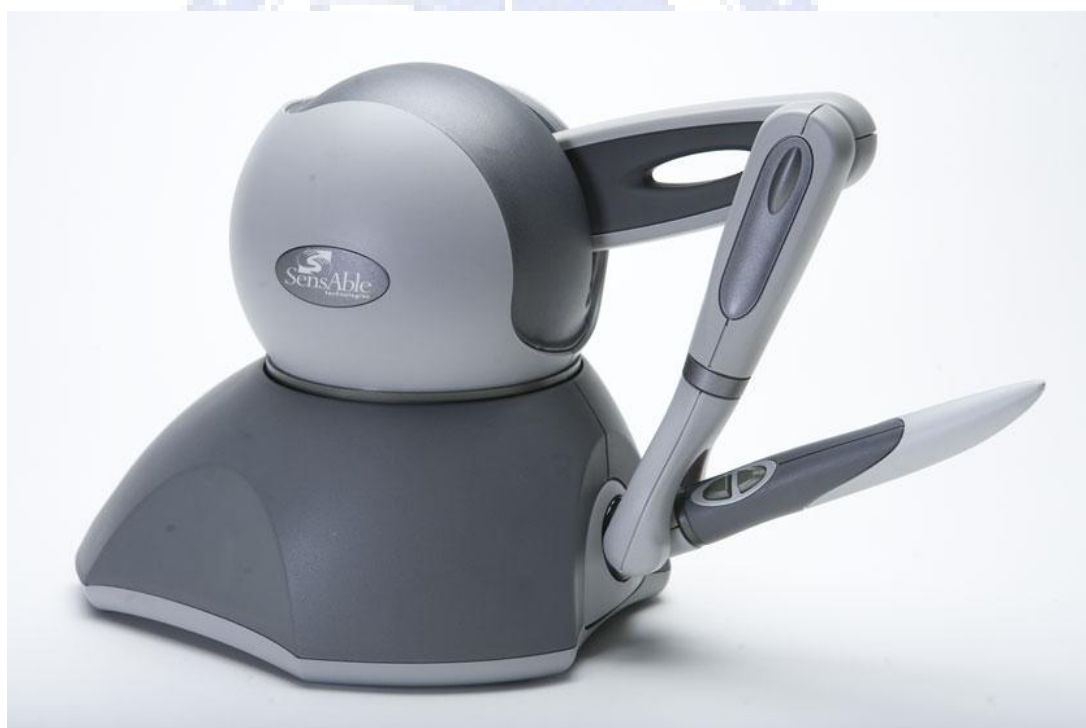
圖 4-2 Phantom Omni 三軸力回饋搖桿[33]
