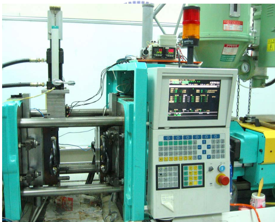
圖 3.11 安裝於射出機上之剪切試驗模具
