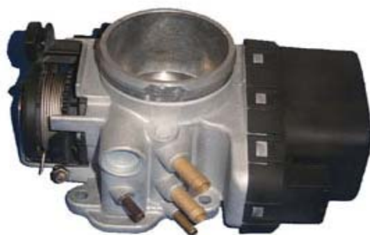
圖 2-2 SAAB 電子節氣門側視圖
