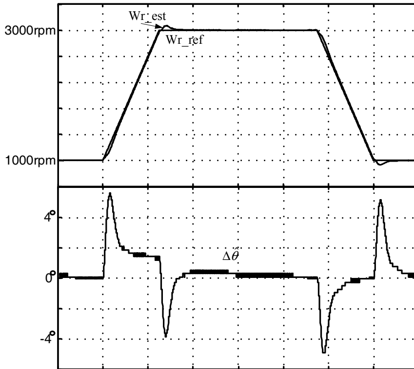
圖 4.7 無感測控制在 1000rpm~3000rpm 暫態模擬結果
