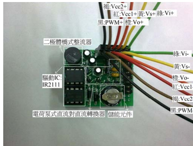
圖 5.10. 實體的獵能裝置之升壓型電荷泵轉換電路
