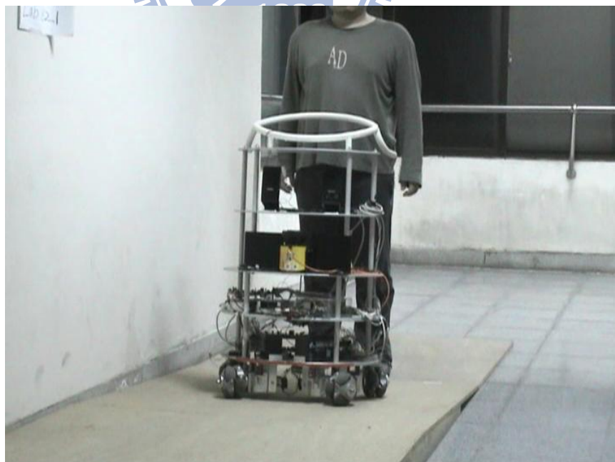
圖 4-14、實驗過程中機器人停留在 4 度斜坡上
