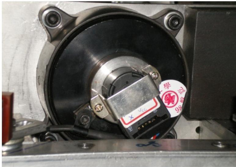
圖3.18 軸編碼器加裝於伺服煞車器
