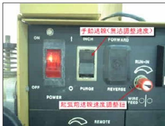
圖 3-6(A) HOBART 2450 型自動送線機之控制
