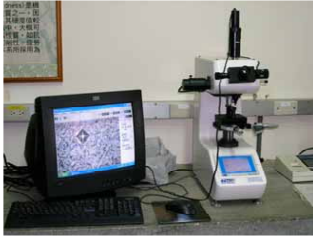
圖 3-16 Matsuzawa MHT-1 微硬度測定機
